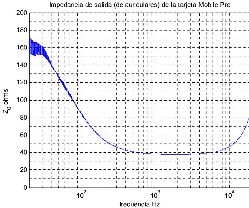
Figura 3. Impedancia de salida de auriculares de la tarjeta Mobile Pre.
